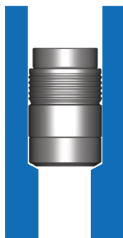
2. Insert Check Valve Ventil einsetzen
