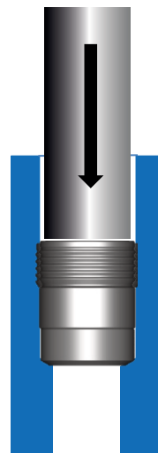
3. Push in pin Pin einpressen
